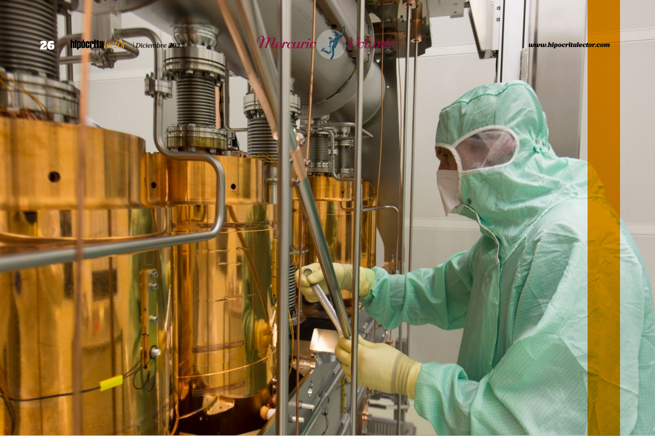
● Ensamblaje de cavidades para el acelerador HIE-ISOLDE (Imagen: Maximilien Brice/CERN).
